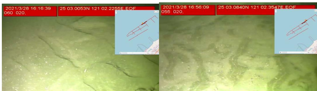
圖 6.1.4-42 粉沙質海床特徵示意圖
