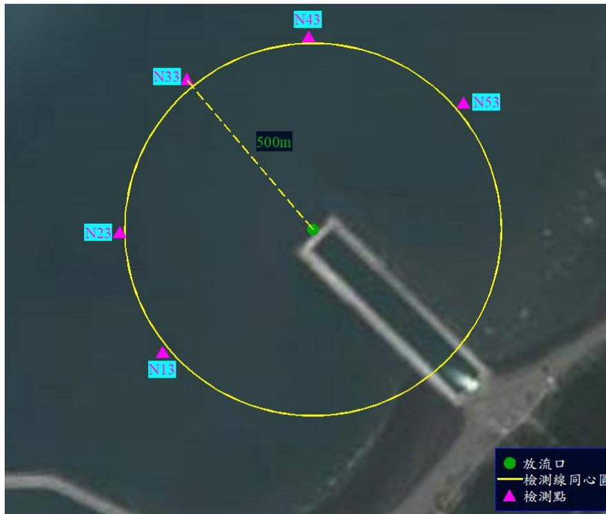
圖 6.2.2.1-1 溫排水出水口檢核點位置示意圖
