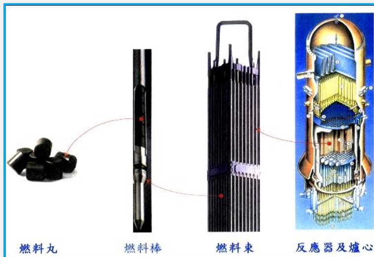
圖 1 核子燃料的製造：核子燃料丸>>燃料棒>>燃料束 [1]
