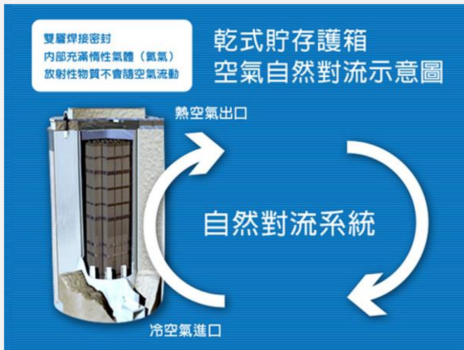
圖 5 乾式貯存箱空氣自然對流示意圖 [2][6]
