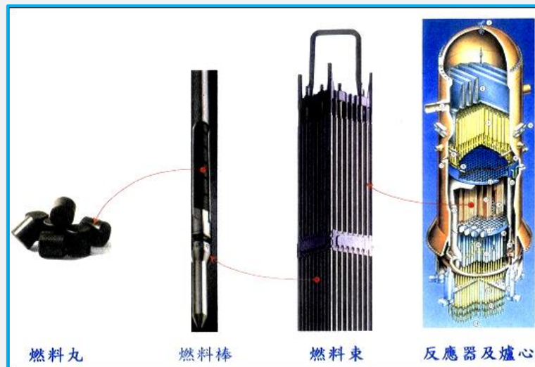
圖 1 核子燃料的製造：核子燃料丸>>燃料棒>>燃料束 [1]
